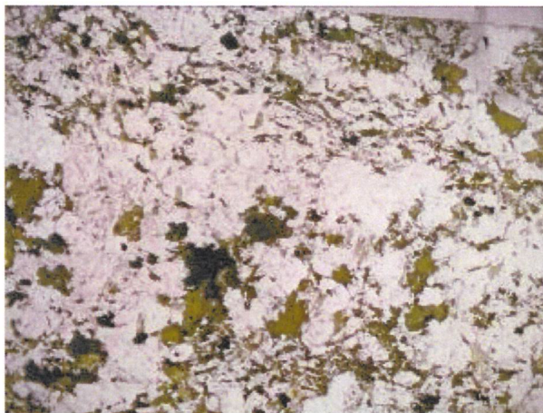
(12) Amostra 7B: Aspecto textural geral da vênula monzonítica, com destaque para texturas distintas de monzodiorito (superior) finamente foliado por biotita e monzonito (porção esquerda da fotografia) com hornblenda em maior proporção que a biotita. Polarizador descruzado. Lado maior = 10,40 mm.
