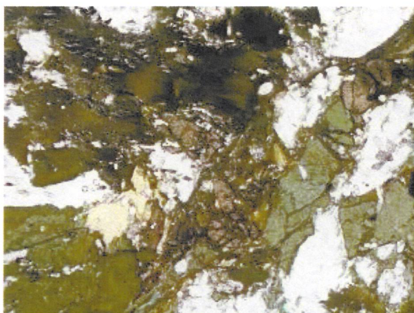
(09) Amostra 11: Associação de biotita, hornblenda e titanita, onde a biotita encontra-se subidiomórfica e a titanita está mais fraturada que a hornblenda. Polarizador descruzado. Lado maior = 3,25 mm.
