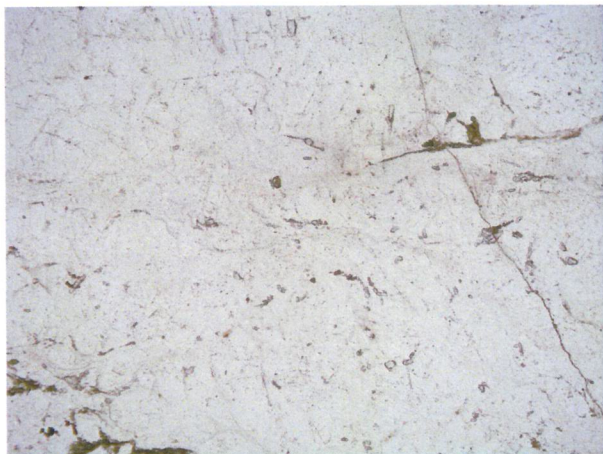
(35) Amostra 3: Destaque para profusão de fraturas no feldspato alcalino com a cominuição de suas bordas mais marcante que o par anterior. Polarizador descruzado. Lado maior = 3,25 mm.
