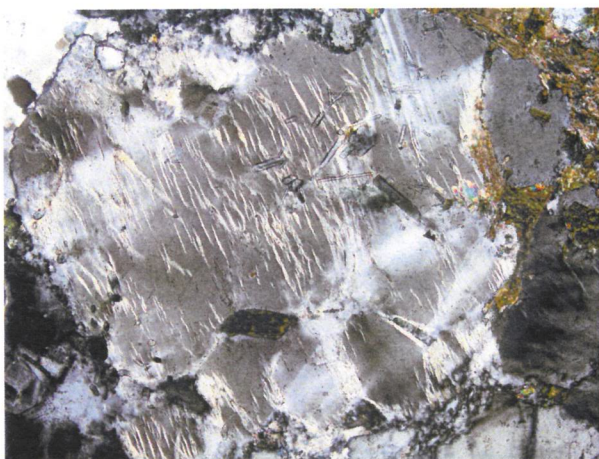
(37) Amostra 3: Exsoluções peritíticas. Polarizador cruzado. Lado maior = 1,30 mm.
