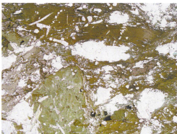
(10) Amostra 11: Porfiroclastos de hornblenda e plagioclásio circundados por biotita com formas e tamanhos variados. Atentar para o porfiroclasto de hornblenda onde há biotita idiomórfica com contato abrupto retilíneo e inclusões de apatita. Polarizador descruzado. Lado maior = 3,25 mm.
