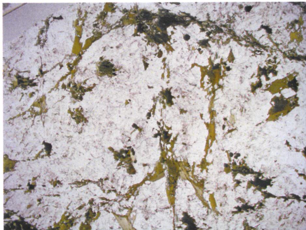
(29) Amostra 5A: Sienito com presença muitos cristais de biotita alongada e ausência de cristais de hornblenda. Nota-se que a textura também é deformada sem afetar a estrutura original da vênula. Polarizador descruzado. Lado maior = 10,40 mm.
